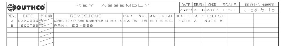
NOTE A: BARREL: CASE HARDENED NOTE B: BRIGHT NICKEL PLATE
